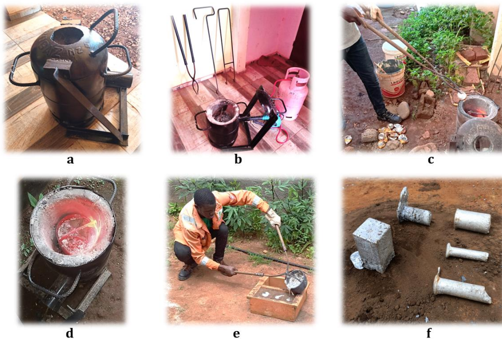
Figure 10 : a : image du four ; b : image de l'ensemble des éléments de la fonderie ; c : image de l'alimentation du four en cannettes usées à recycler lors du test de fonte ; d : image qui met en exergue l'aluminium liquide dans le creuset chauffé à l'intérieur du four ; e : image de l'opération de coulée pour un moulage au sable ; f : image des pièces obtenues après démoulage.
