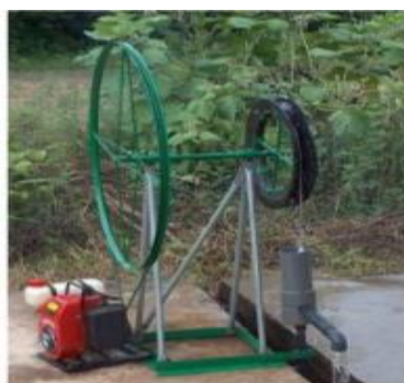
Figure 2. Pompe à nœud de corde motorisée
