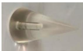
**Figure 3 :** Sonde conique en plastique (angle  $30^\circ\text{C}$ ), choisie pour minimiser les effets de bords du contenant.
