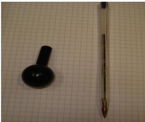
**Figure 1** : Douille utilisée pour l'analyse texturale.
