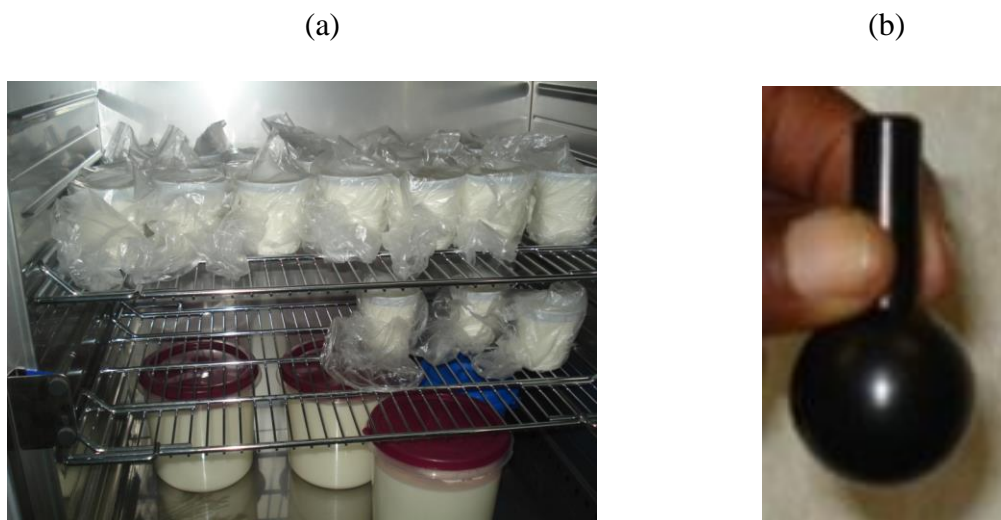
Figure 3 : (a) : Disposition des échantillons dans l'étuve pour le suivi de l'évolution du pH. (b) : Douille du texturomètre, utilisée pour la mesure de la fermeté des fromages
